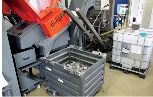
3 Handliche und trockene Briketts: Mit der Ruf-Brikettierpresse vereinfacht die Euler das Handling der Produktionsreste stark. Ein Container nimmt das ausgepresste Kühlschmiermittel auf © Ruf
